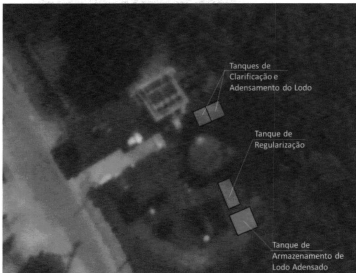
Figura 4 - Layout preliminar proposto para a implantação do sistema de tratamento dos efluentes
