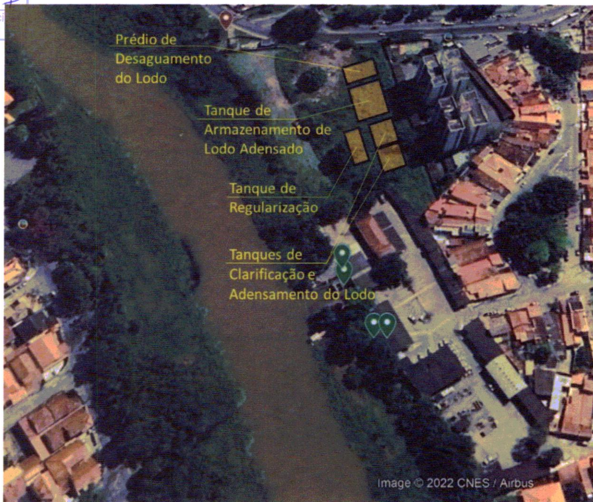
Figura 3 - Layout preliminar proposto para a implantação do sistema de tratamento dos efluentes junto à ECA
