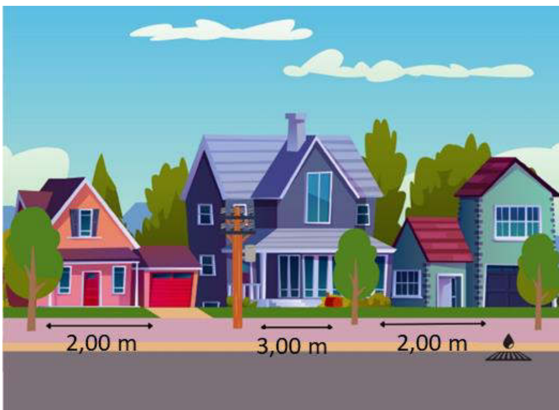
Figura 102: Distâncias mínimas recomendadas entre as árvores e os equipamentos urbanos de Jacareí/SP.
