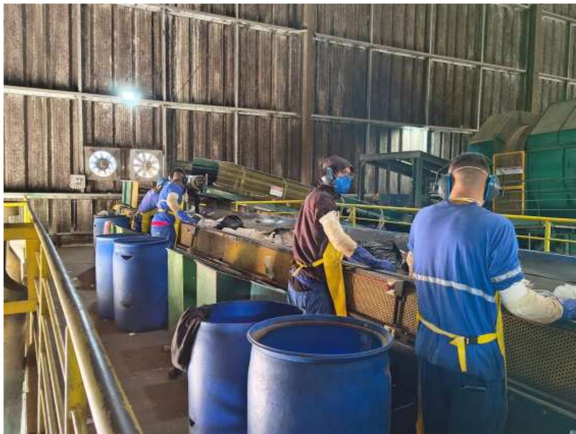
Figura 5: Esteira de separação manual e grande quantidade de sacos inteiros
