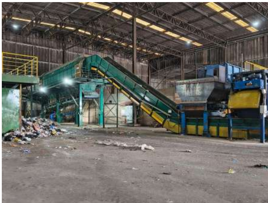
Figura 2: Rasga-saco, esteira e separador
